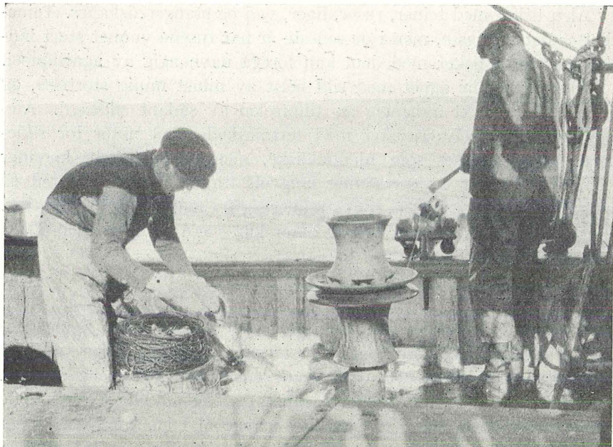
54. Liner drages med motorspill. Fot. forf.
