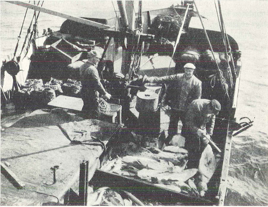
Fig. 43. Bankliner drages med damlinespill. Fot. forf.
