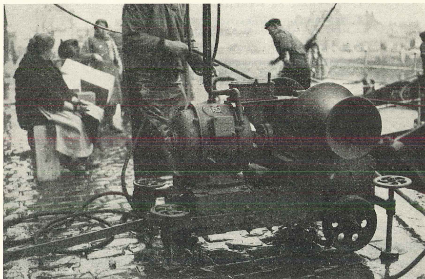
Fig. 5. Transportabelt elektrisk spill til innheising av fisk.
