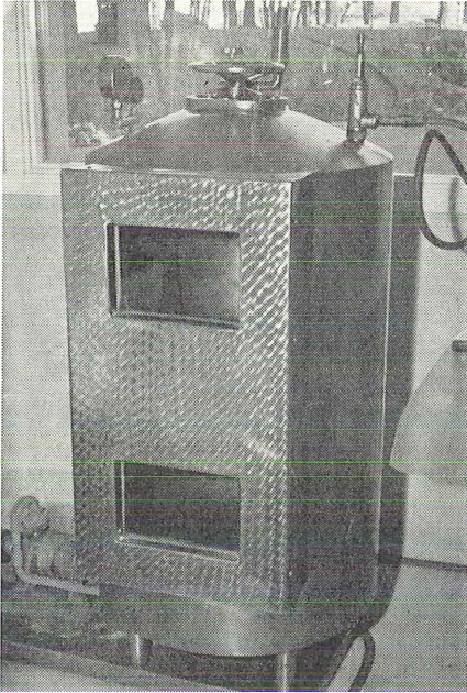
Trykkakvarium for trykk opptil 10 atmosfærer, konstruert av G. Sundnes.
