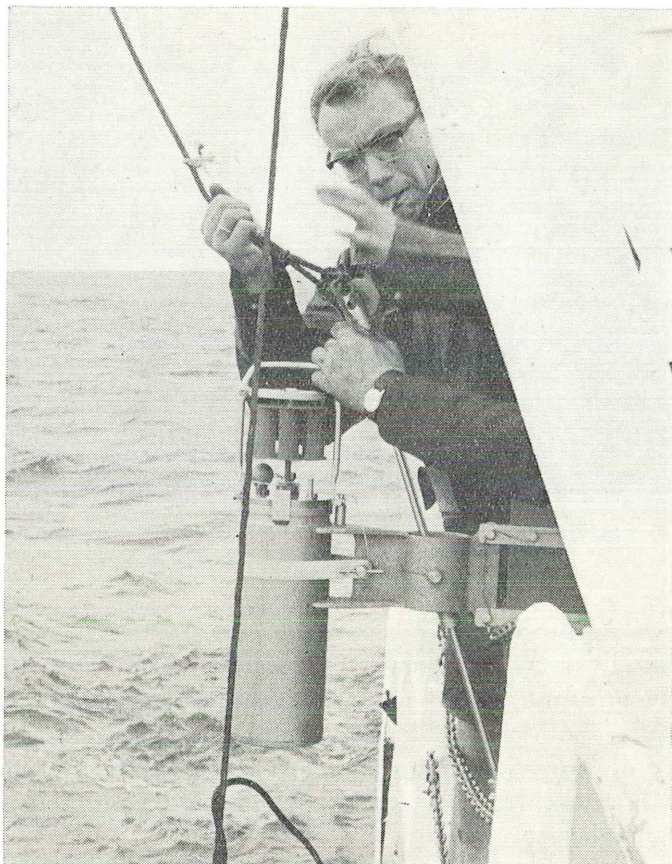
Fig. 3. Utsetting av selvregistrerende instrument for observasjoner av strømretning, strømstyrke og temperatur. (Foto: O. Alveim.)
