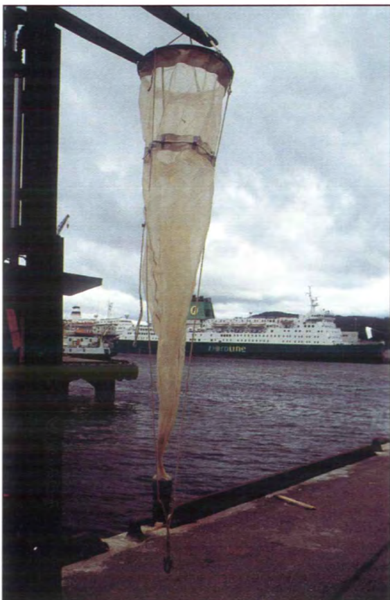
WP II har en diameter på 80 cm. Håven senkes ned til ønsket dyp og fanger små planktonorganismer mens den hales opp til overflaten. Foto: Synnøve T. Stub.
