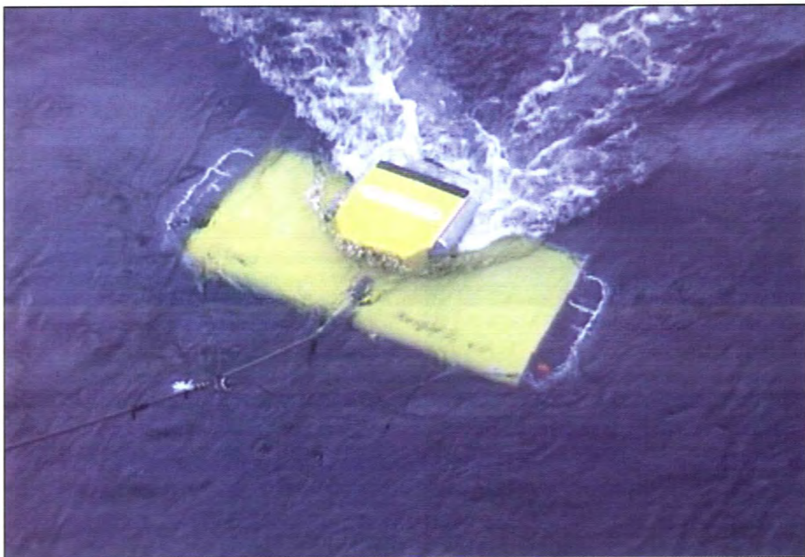
OPC er en planktonteller som gjennom en sensor kan registrere hvor mye plankton som finnes i et bestemt havområde. Foto: Are Edvardsen.
