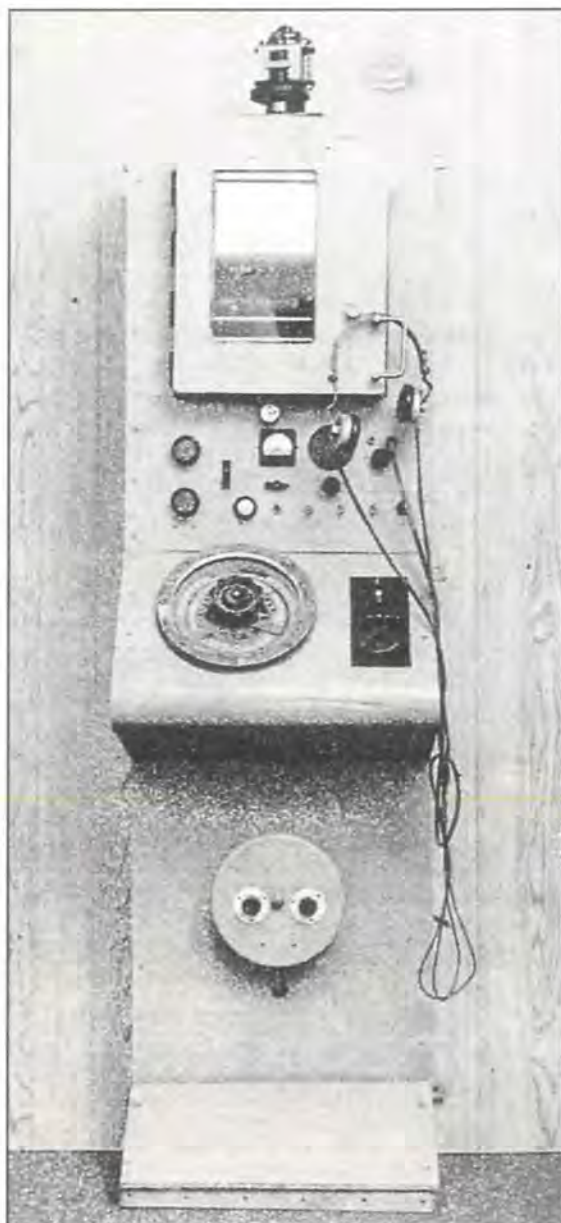
Fig. 2. Operatørdelen av ASDIC ombord i «G.O. Sars», 1950.
