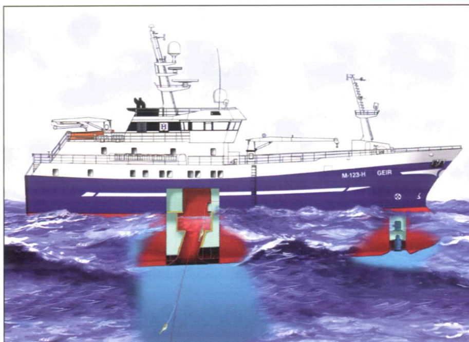
Illustrasjonen viser M/S «Geir», og hvordan autolinen automatisk går gjennom dragerbrønnen.
