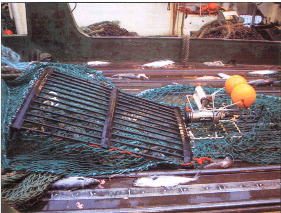
Det ble gjort undervannsoptak som viste at småfisk som kommer inn i trålen har en lett berøring av rista i seleksjonsfasen. (Foto: Snorre Angell)
