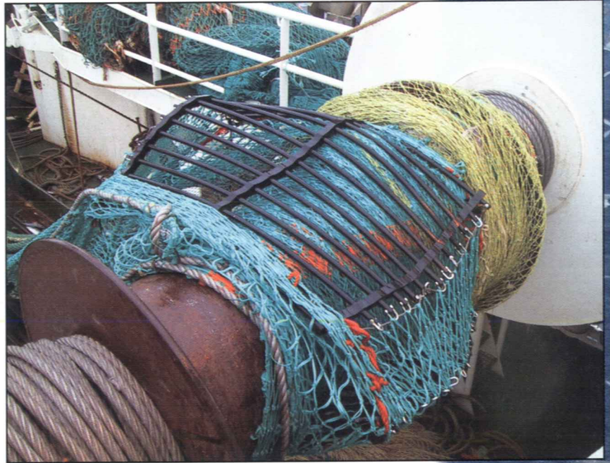
Sorteringsrista er godt egnet for så vel små fartøyer som store på grunn av at rista kan «kjøres» inn på trålløllen. (Foto: Snorre Angell)
