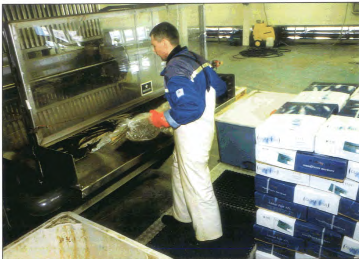
Global Ålesund har montert den første fullskala tiningmaskinen som fører til mer skånsom tining av fisken og bedre kvalitet, samtidig som det blir mindre fisk som må sorteres bort.
