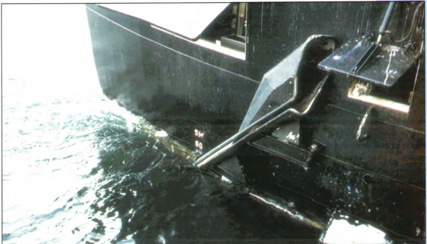
«Sjøviknes» er den eneste båten som pr. i dag har fått montert Mustads setterør. Når den ikke er i bruk, vis den til side som her.
