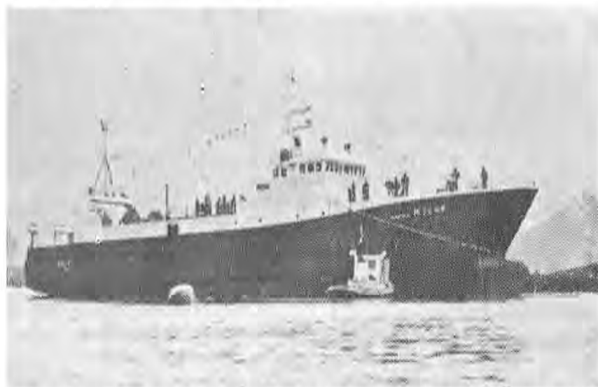
Hekktråleren «Remøytrål» som leverte 203 tonn grønlandsreker i Ålesund. Båten er bygd ved Svolvær Mek. Verksted i 1975, og er 147,2 fot, 483 bruttotonn. «Remøytrål» eies av Per. J. Remøy P/R, Leinøy.
