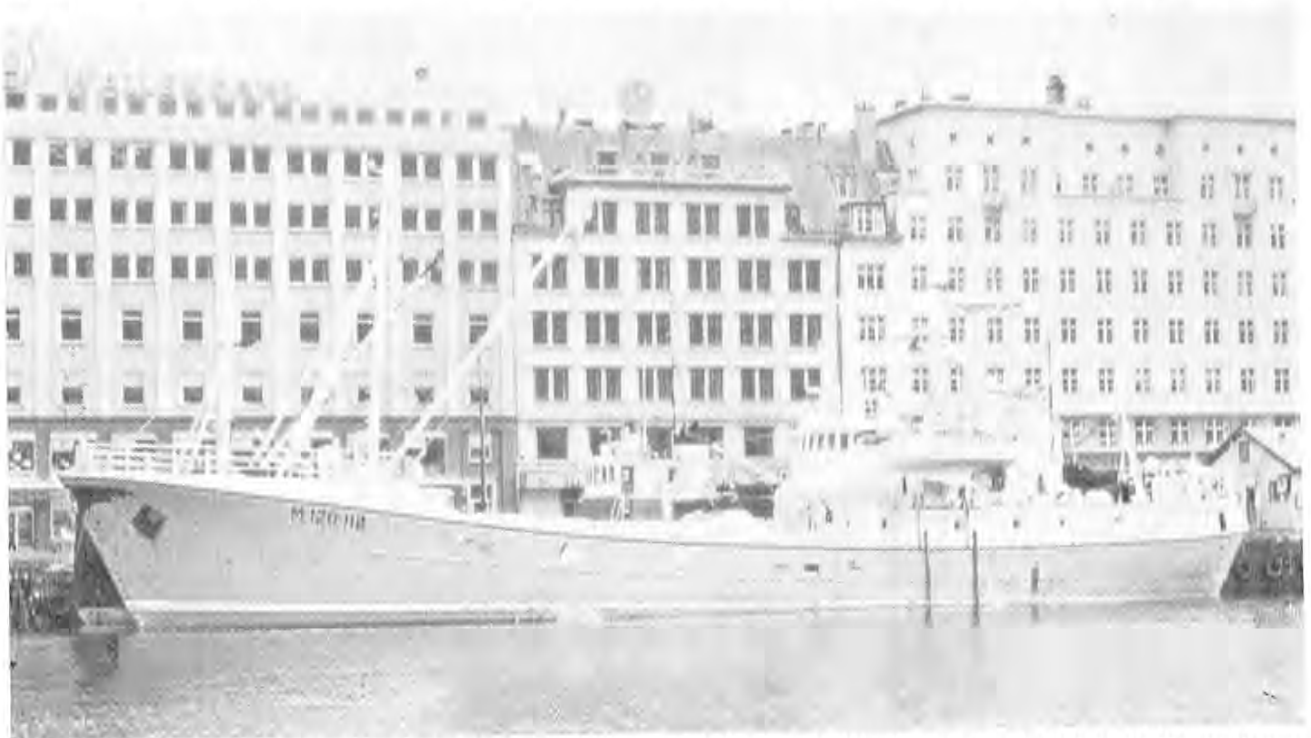
«Teigenes» av Herøy i Møre og Romsdal, gjorde «årets kast» da båten tok en fangst på 3 800 hl nordsjøfisk like før helga. Denne uka kom fangsten vel i havn. «Teigenes» er 155,9 fot lang og 428 bruttotonn. Båten blei bygd ved Hatløy Verksted, Ulsteinvik 1966. Med shelterdekk som «Teigenes» fikk i fjor, laster båten 6 650 hl. Båten eies av Terje Teige mfl., Fosnavåg.
