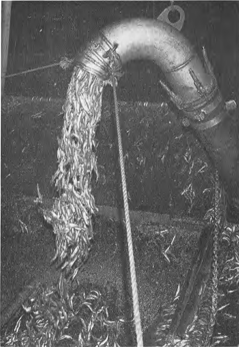
Her ser vi mottakstrakten på fabrikk i land og avløpet av pumpeanlegget som er tilknyttet båten.
