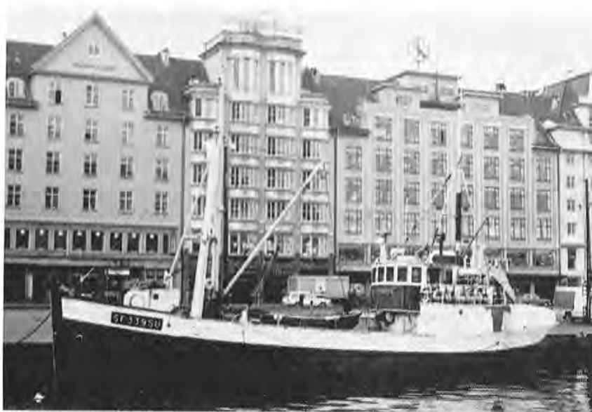
Rogalandsbåten «Bådsvik» gjorde det best av størjebåtene denne uka. Men med to fangster på henholdsvis 38 og 42 størjer, skulle mannskapet på «Saltskaaren» også ha grunn til å være fornøyd. «Saltskaaren» er 65 fot lang, 50 bruttotonn, bygd av tre i 1937. Båten eies av Anton Saltskår, Buskøy. (Foto: Per Alsaker).
