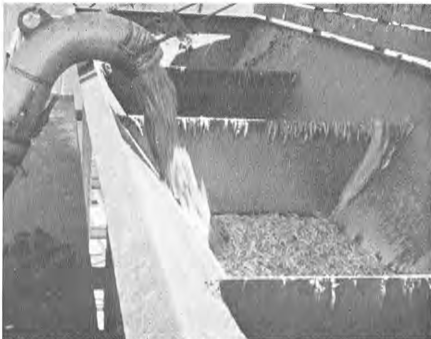
Dette bildet viser utløpet av pumpa, og det er lossing av tobis som foregår. (Foto: Olav Meland).
