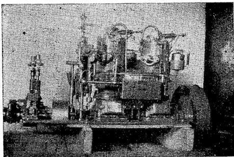
I den skarpe kappestriden på alle umkverve spørst det um å skaffa seg den beste og tryggaste motoren. I kraft, tryggleik og billeg drift stend „Wichmann“-motoren millom dei fremste. Motoren vert levert i storleikar frå 2-400 hk. Større motorar vert utstyrde med hydraulisk reversering, og sirkulasjonspumpa for smyrjeolja.
