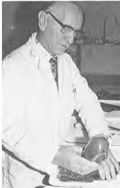
Dagfinn Hakvåg på Sentrallaboratoriet bruker her eit såkalla torymeter til å måle kor fersk fisken er. Torymeteret er eit nytt instrument til dette bruk, og det blir nå utprøvd på Sentrallaboratoriet.
