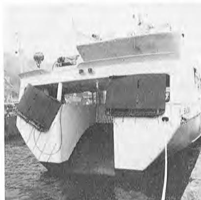
«Bien Dong» er bygd som hekktrålar, men kan nyttast i kombinert drift.
