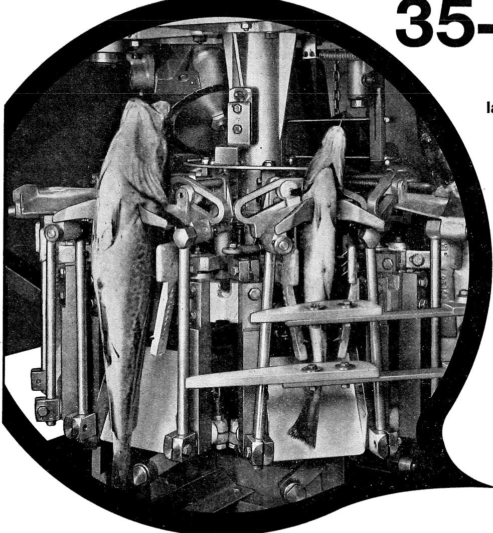
lang torsk, sei og hyse kan sløytes uten omstilling på denne nye maskin. Kverken gjennomkjæres så innvollene løsner. Buken åpnes med et glatt snitt og innvollene tas ut. Om ønskelig kan hodekutter innbygges.
