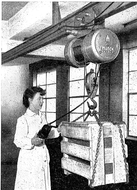
Elektrotalje med skyvbar løpekatt, 1 tonn.
