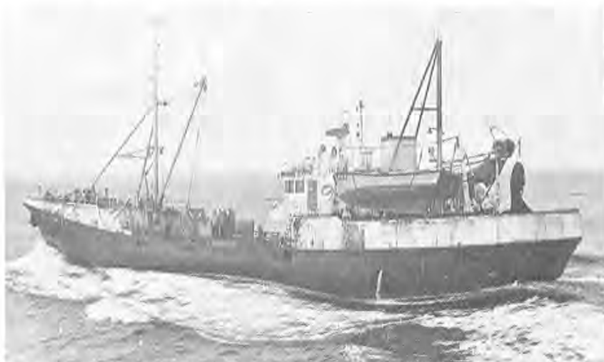
«AKSLA» er representativ for den type havfiskefartøyer som ble bygd omkring 1950 og som ble benyttet både som snurpere og som linefartøyer. Fartøyet ble bygd som «FLØMANN» ved A.M. Liaaens Skipsverft, Ålesund i 1951 og ble i 1971 overtatt av Ole Edvardsen, Ålesund. Fartøyet er 135,2 fot i l., 284 brt og laster 3000 hl. Foto: Dag Bakka Jr.
