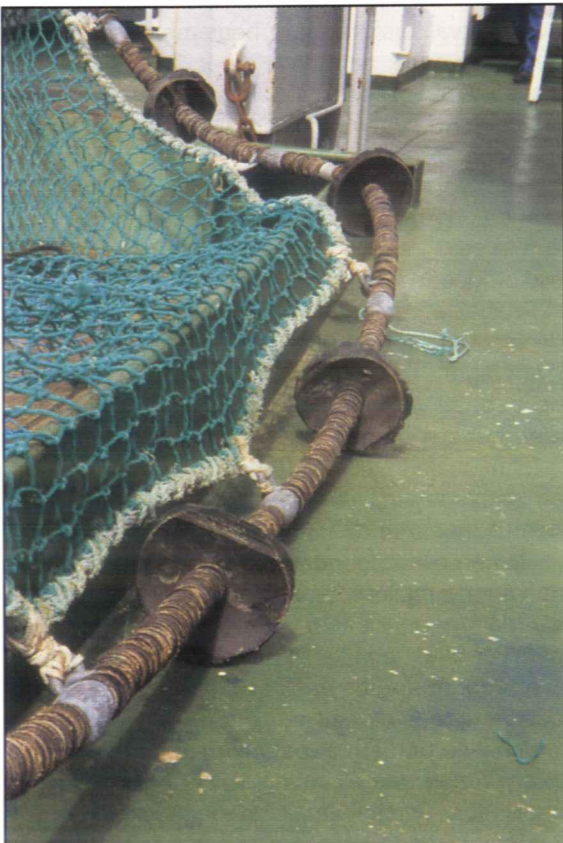
Et lett bobbings gear, som her, har en viss mulighet til å passere steinfylte rørledninger uten å bli revet.
