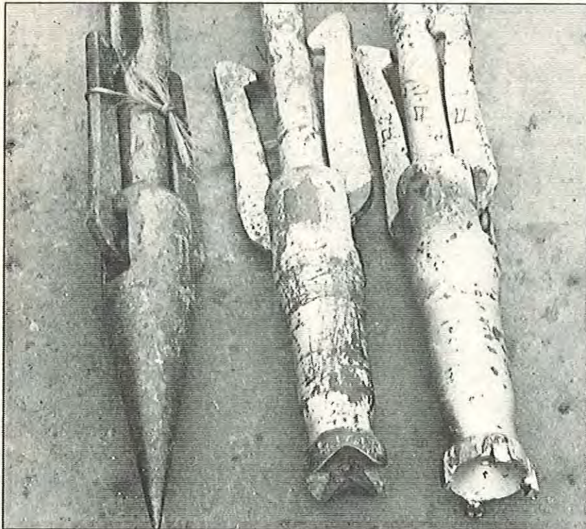
Egil Øen har konstruert harpuner som er butte i spissen. Her er to av dem med den harpuntutypen som brukes idag til venstre i bildet.
