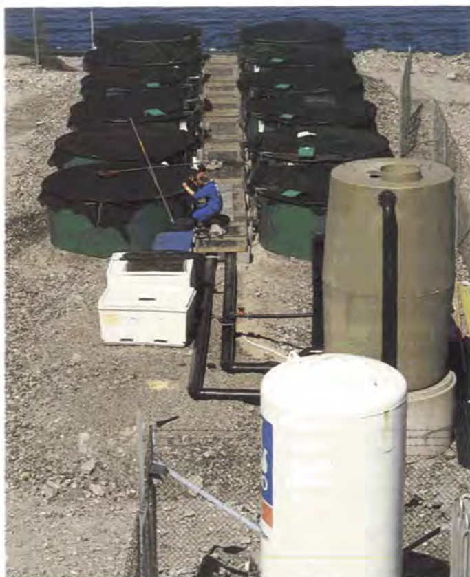
Oversiktsbilde over tetthetsriggen. Den hvite tanken i forgrunnen inneholder flytende oksygen, den grønne er reservoartank for råvann. De to rørledningene mellom karene leverer henholdsvis oksygenert og uoksygenert vann til blandedbatteriet for hvert kar. Selve oksygeninnløsningsenheten er skjult bak reservoartanken.
