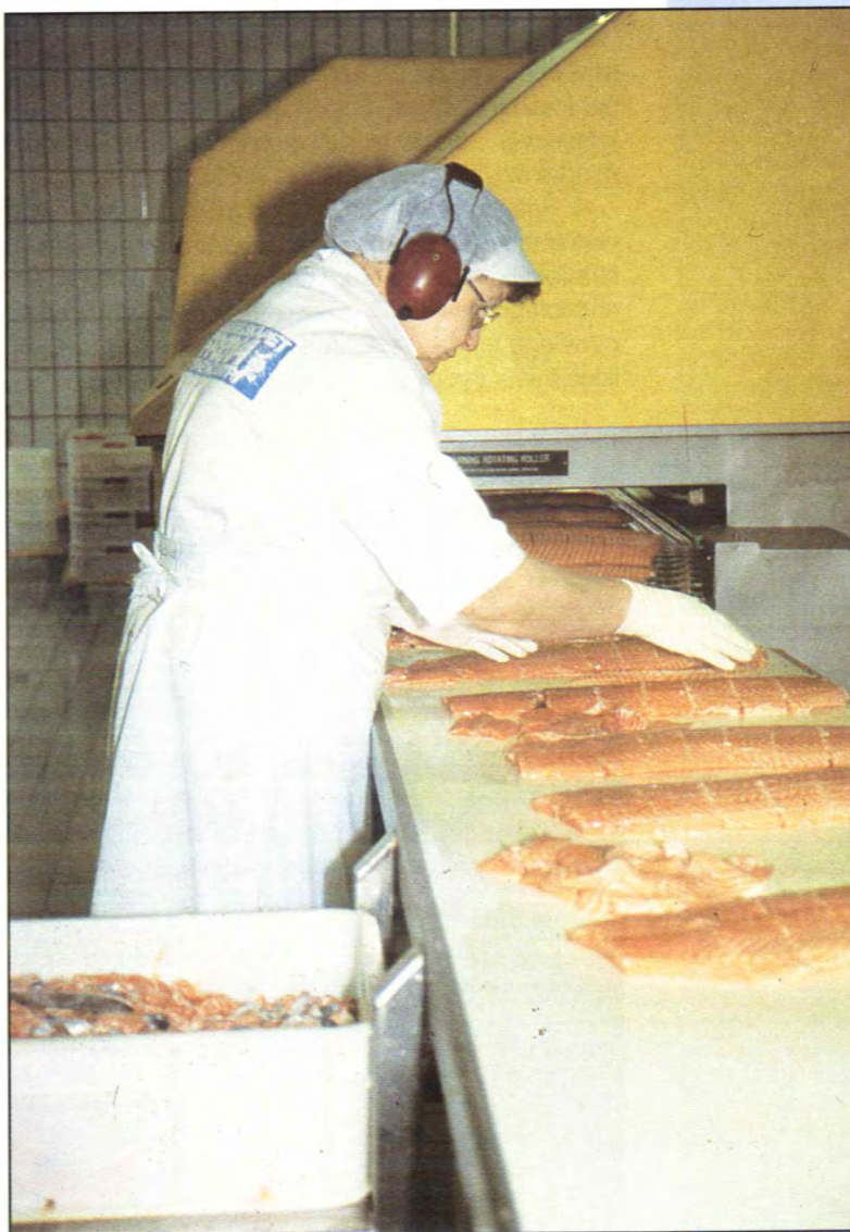
Produksjon av laks er hypermoderne hjå Frøya Fiskeindustri. Filetane kjem ut nøyaktig tilskorne av den datastyrt maskina i bakgrunnen.
