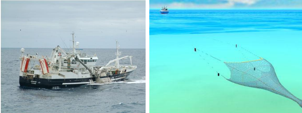
Figur 17. Bilde av en pelagisk tråler og illustrasjon av en pelagisk trål.
