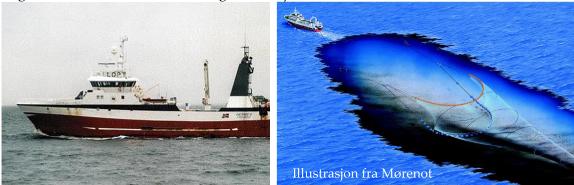
Figur 13. Bilde av en hekktråler og illustrasjon av en enkel bunntrawl.
