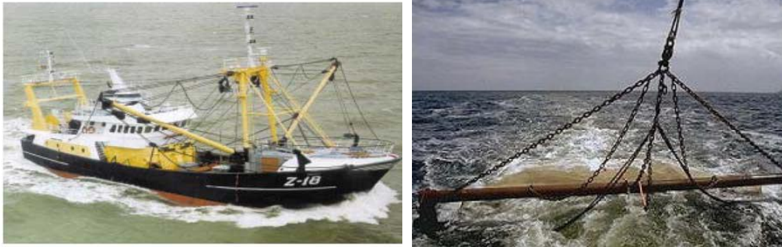
Figur 16. Bilde av en typisk bomtråler og trållarrangementet som fartøyet sleper.
