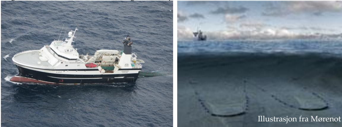
Figur 14. Bilde av en hekktråler og illustrasjon av en dobbel bunntrawl.
