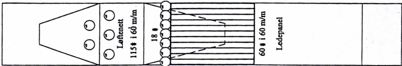
Fig. 3 Ristsystemet sett ovenfra.
