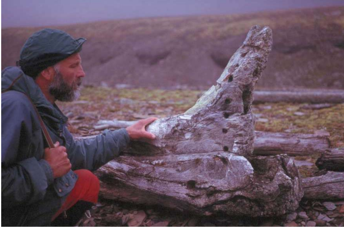
Skipskjølen på Bjørnestranda tyder på at vraket er svært gammelt. Kun trenagler er brukt. Foto: 31/8-2001 HKB (P01-12-21)
