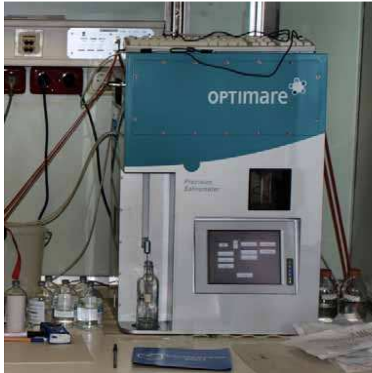
Fig. 3.1.2: Optimare Precision Salinometer (OPS)
