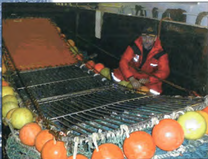
Robert Misund viser frem sorteringsristen som brukes i torsketral. For sile ut fisk med et minstemål, gjør man forsøk for å finne frem til ideelle mål på spileavstand og maskevidde. Foto: Roger Larsen
