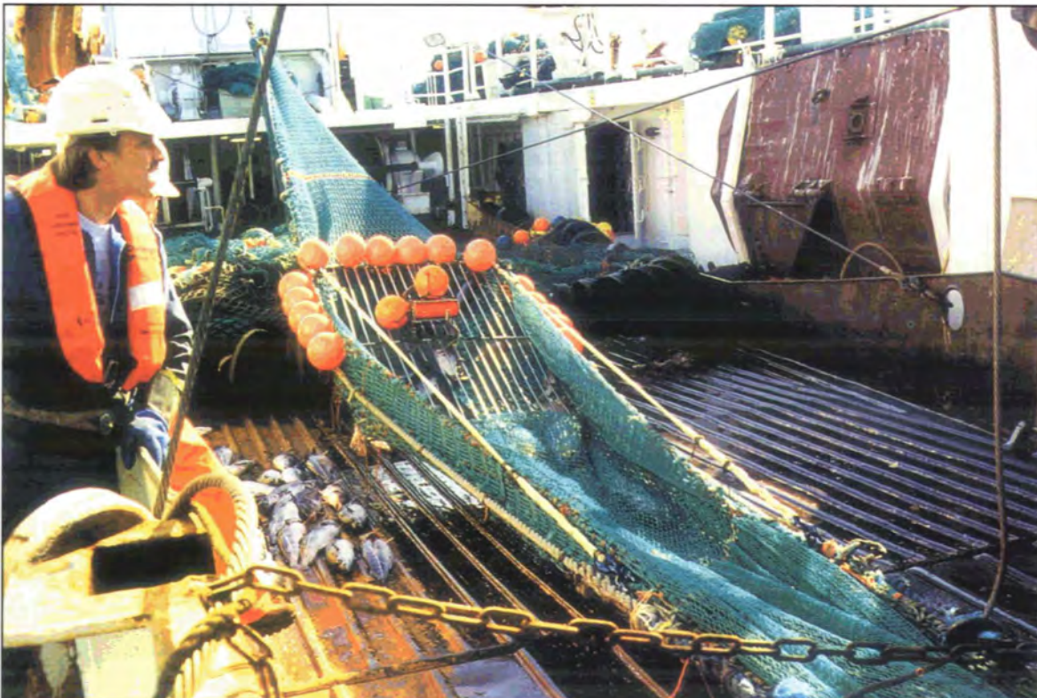
Dette er den små håndterlige sorteringsristen som Havforskningsinstituttet har utviklet.
