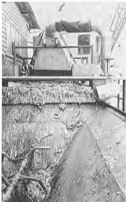
Før kolmula blir målt, går den via ein sil (øverst på bildet). Vatnet blir deretter brukt omatt.
