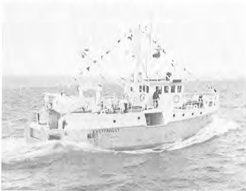
«Kystfangst» har to motorer hver på 260 hk som går på en felles propell via et reduksjonsgear. Her ser vi båten for full maskin.
