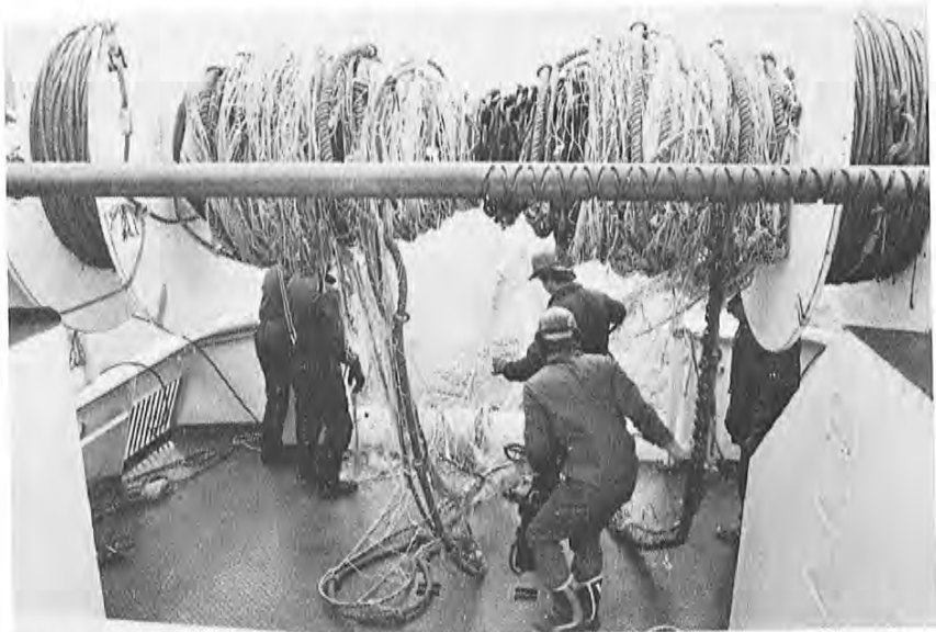
Pose med trålbelg er ute og vingene går ut. Ellers viser bildet kombinasjonsvinsjen sett forfra. På samme aksling har man trommel for trålwire (ytterst) og trommel for trål. Dessuten er det en hydraulisk motor på hver ende av akslingen.
