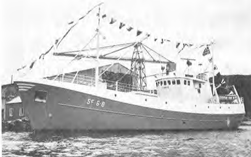
«Førde» av Bremanger var beste pigghåbåt denne uken. Den leverte 120 tonn i Måløy. Skipper om bord er Erling Førde, som også eier båten. «Førde» er 109,2 fot lang, og 228 bruttotonn. Båten ble bygd ved A/S Eidsvik Skipsbyggeri i Uskedalen i 1973. «Førde» har Mustad Autoline egnemaskin om bord.
