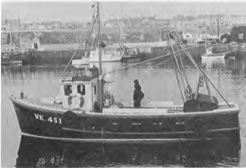
Mange nyere «inshore»-båter er bygd av glassfiberarmert plast. «Drumbeat» av Wick på 36 fot, er en typisk representant for disse. Båten ble bygd ved Hatmatic (Scotland) i Kirkwall på Orknøyene i 1975. «Drumbeat» er utstyrt for småtråling og linefiske. Men båter av denne typen brukes også til garnfiske, krabbefiske, etc.
