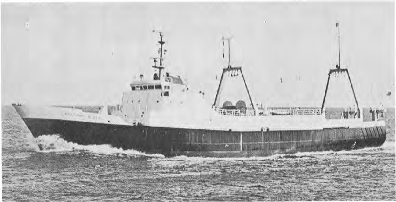
Moderne britisk «distant water» tråler. «Princess Anne» av Hull er en frysetråler på 251 fot. Tråleren ble levert fra Clelands Shipbuilding Co Ltd., Wallsend-on-Tyne i september 1974.
