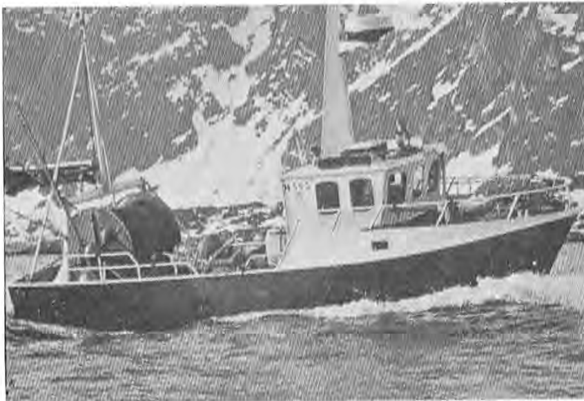
Arbeidet ved Fartøyseksjonen er for tida konsentrert om kystfiskeflåten og mindre havgående fartøyer. En tar sikte på å utvikle fartøytper som bl.a. kan gi lønnsom drift og som kan redusere arbeidskraftbehovet om bord. Dette bildet er fra forsøkene med mekanisert garndrift på en 35 fots sjark.
