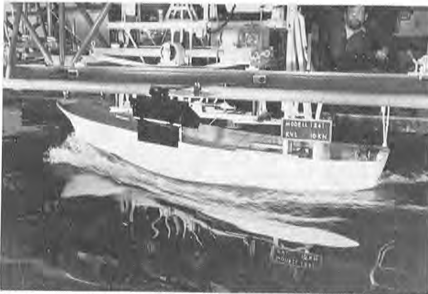
Modellprøving har bestandig stått sentralt i utprøvingen av nye fartøytyper. Her ser vi modell av et skrog som blir utprøvd i Skipsmodelltanken i Trondheim.
