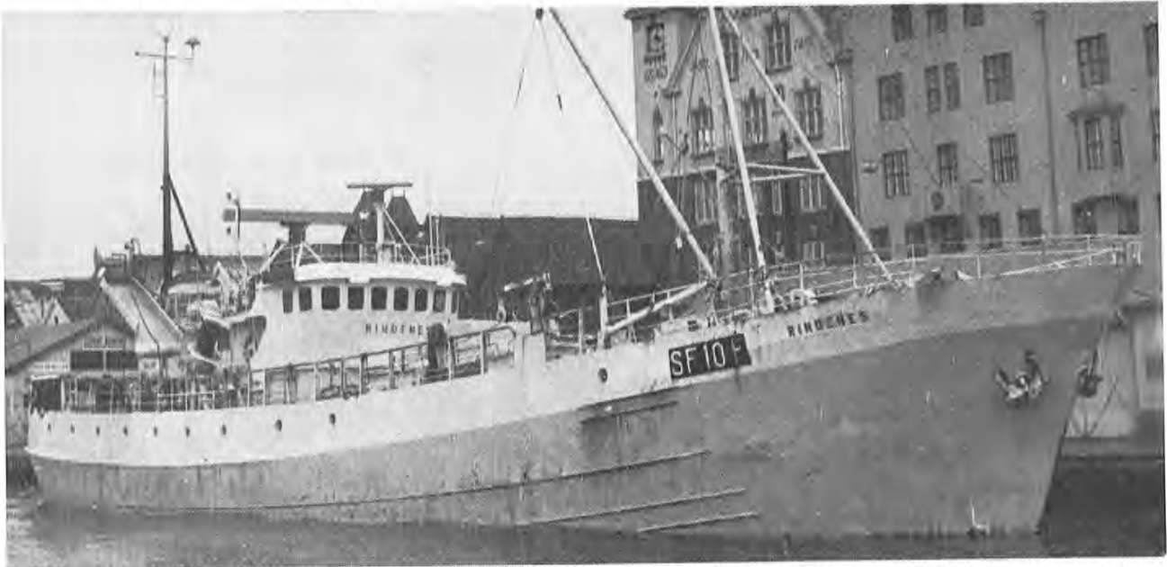
Nordsjøspesialisten «Rindenes» har greidd fire turer med havbrisling siden fisket åpna 30. september. «Rindenes» er 116 fot, 244 bruttotonn, bygd i 1956. Båten har Wichmann hovedmotor på 825 bhk. «Rindenes» eies av Olav Mortensen m.fl., Florø.
