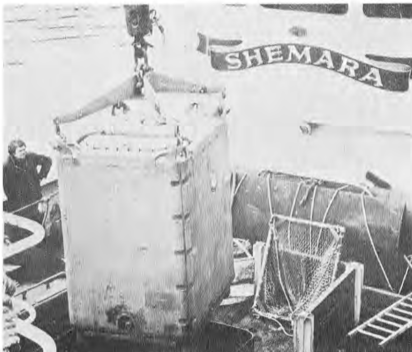
Her leverer «Shemara» containerført kolmule nedkjølt i sjøvann til en fabrikk i Stornoway. (Foto: WFA).
