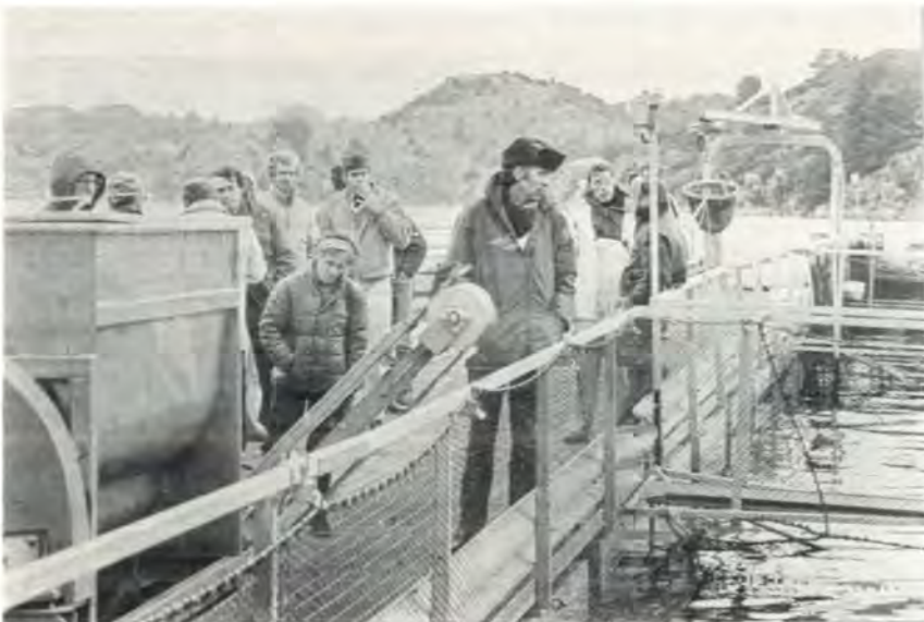
Her vert føringsmaskina demonstrert. Med denne maskina kan ein person utan særleg slit føra fisken i eit 8 000 kbm stort anlegg heilt aleine. Ved hjelp av ein computer kan oppdrettarane styra utmatinga av tørrfôr.
