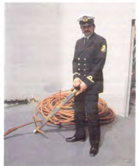
Kystvaktinspektør Rune Furevik med den nykonstruerte dreggen som gjør det mulig å finne igjen trål som er kuttet.
