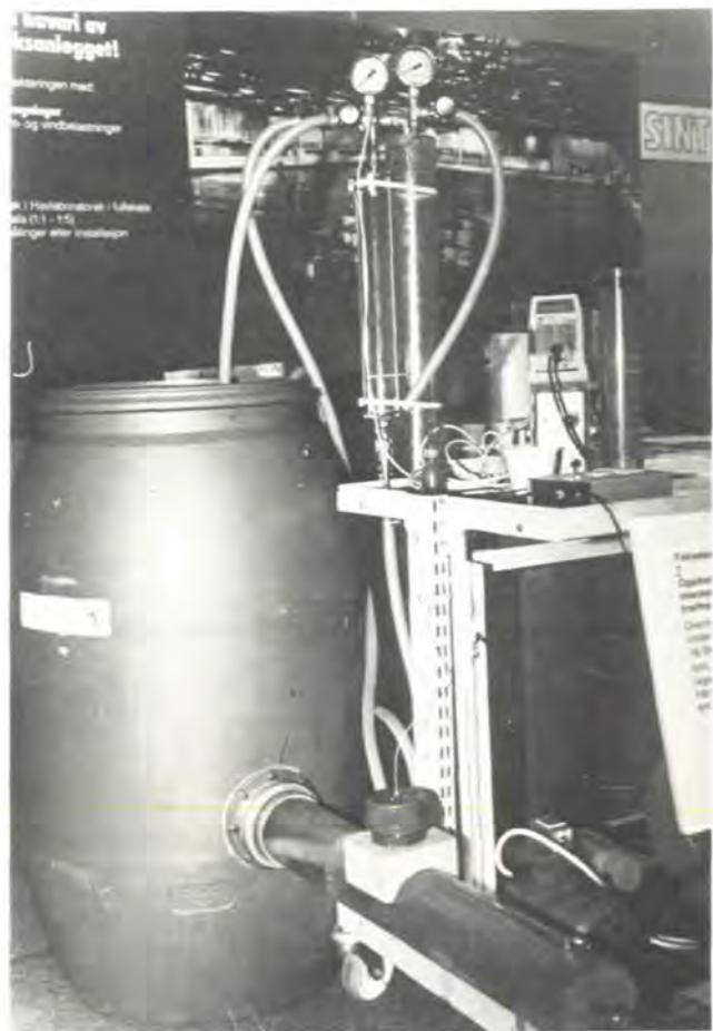
Det er viktig å holde kontroll med nitrogeninnholdet i vannet i et anlegg, for høgt nitrogeninnhold kan nemlig føre til fiskedød. SINTEF har utviklet disse måleinstrumentene, som i tillegg til å overvåke luftinnholdet, varsler dersom det blir for høgt.
