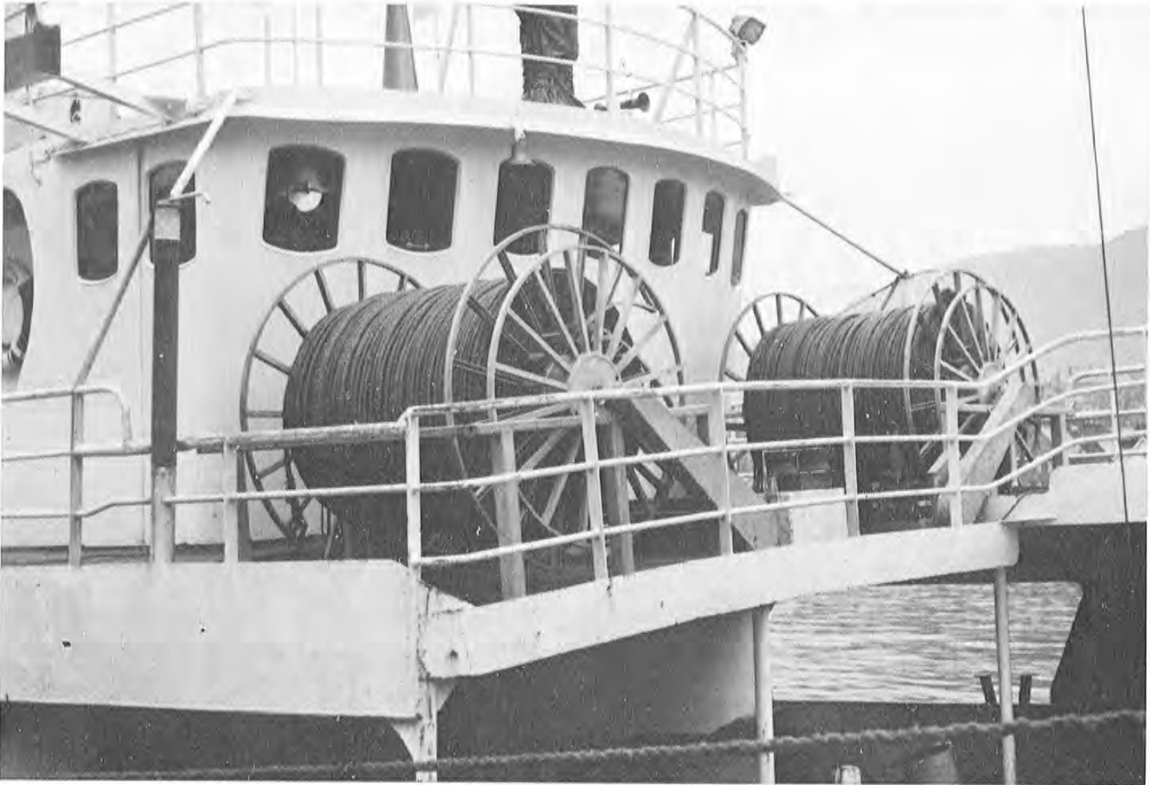
Denne plasseringa av tannromlane er «Vestervon» aleine om. Men skottane har fått interesse for løysinga. Fordelen med dette arrangementet er at dekket blir fritt for tauverk slik at det er lettare og framfor alt tryggare å arbeida der. Tromlane er norskproduserte, men til nå mest berre brukt av britar.
