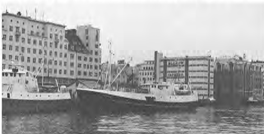
SF-84-A «Vestervon» er 99,2 engelske fot lang og 203 bruttotonn. Båten vart bygd som banklinefartøy i 1969. Hovudmotoren er ein Wichmann på 300 HK. Det er Ingolf Fedøy m.fl., Bulandet, som eig «Vestervon».
