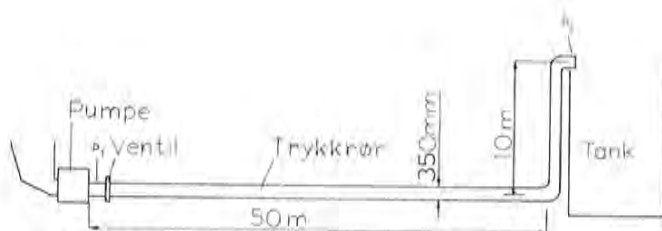
Fig. 12: Trykkrør fra pumpe til tank.
