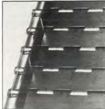
Type 50 – plate link, deling 50 mm. Pladetykkelse 1,25 mm med eller uden perforering. Med eller uden sidekæder. Kan forsynes med sideplader og medbringere. I rustfrit stål, syrefast og galvaniseret.
