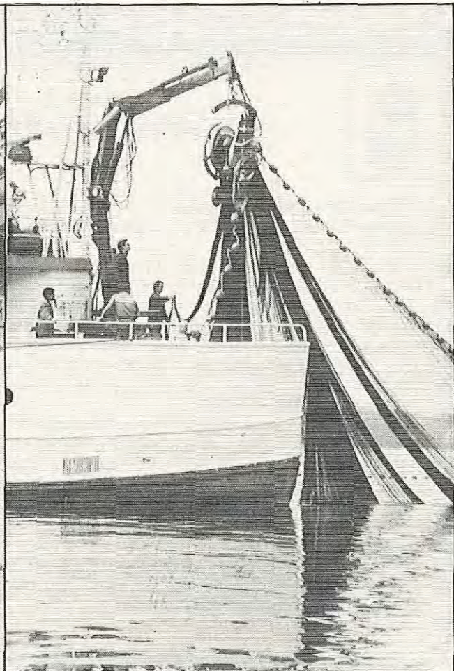
Haneføtene går over blokka ved hjelp av knastane på mebringarhjulet.
