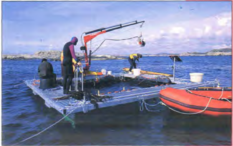
Innsamling av fisk og tare med «fallnot». Redskapet kan ta prøver ned til 9 m dyp.
