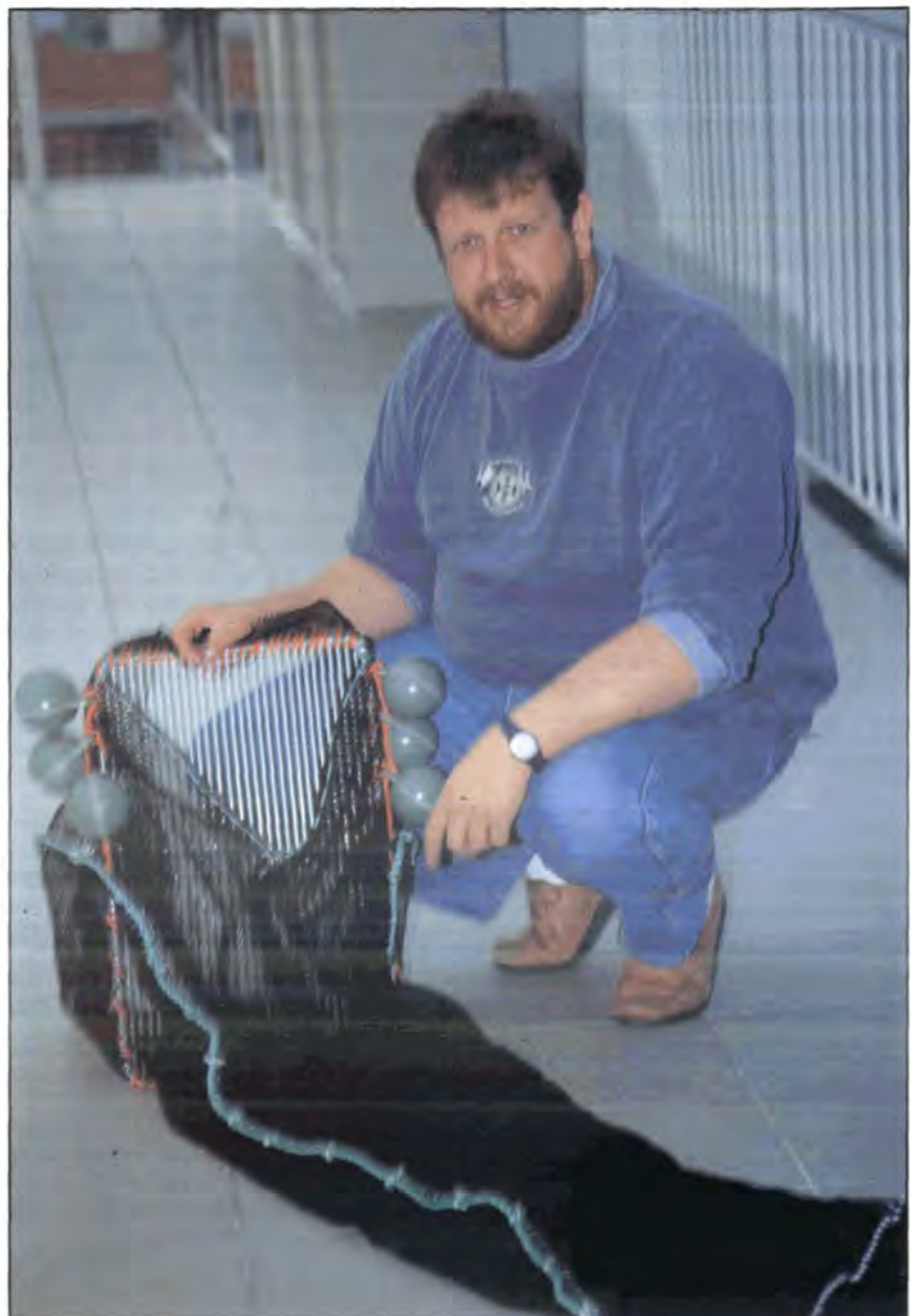
Bjarne Schultz ved Kontoret for fiskeforskning og veiledning i Fiskeridirektoratet med en miniutgave av reke-trål med sorteringsrist.
