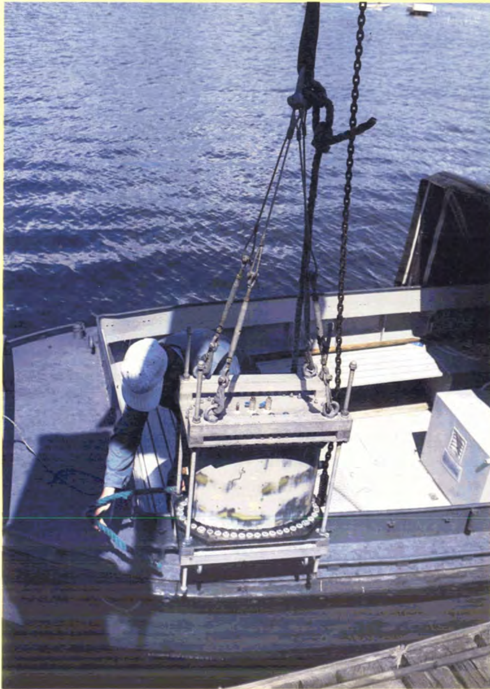
Den såkalte transduceren festes til seismiske fartøy via en hydrofonisk kabel. Slik kan man på en miljøvennlig måte danne seg et bilde av de geologiske forholdene på havbunnen.
