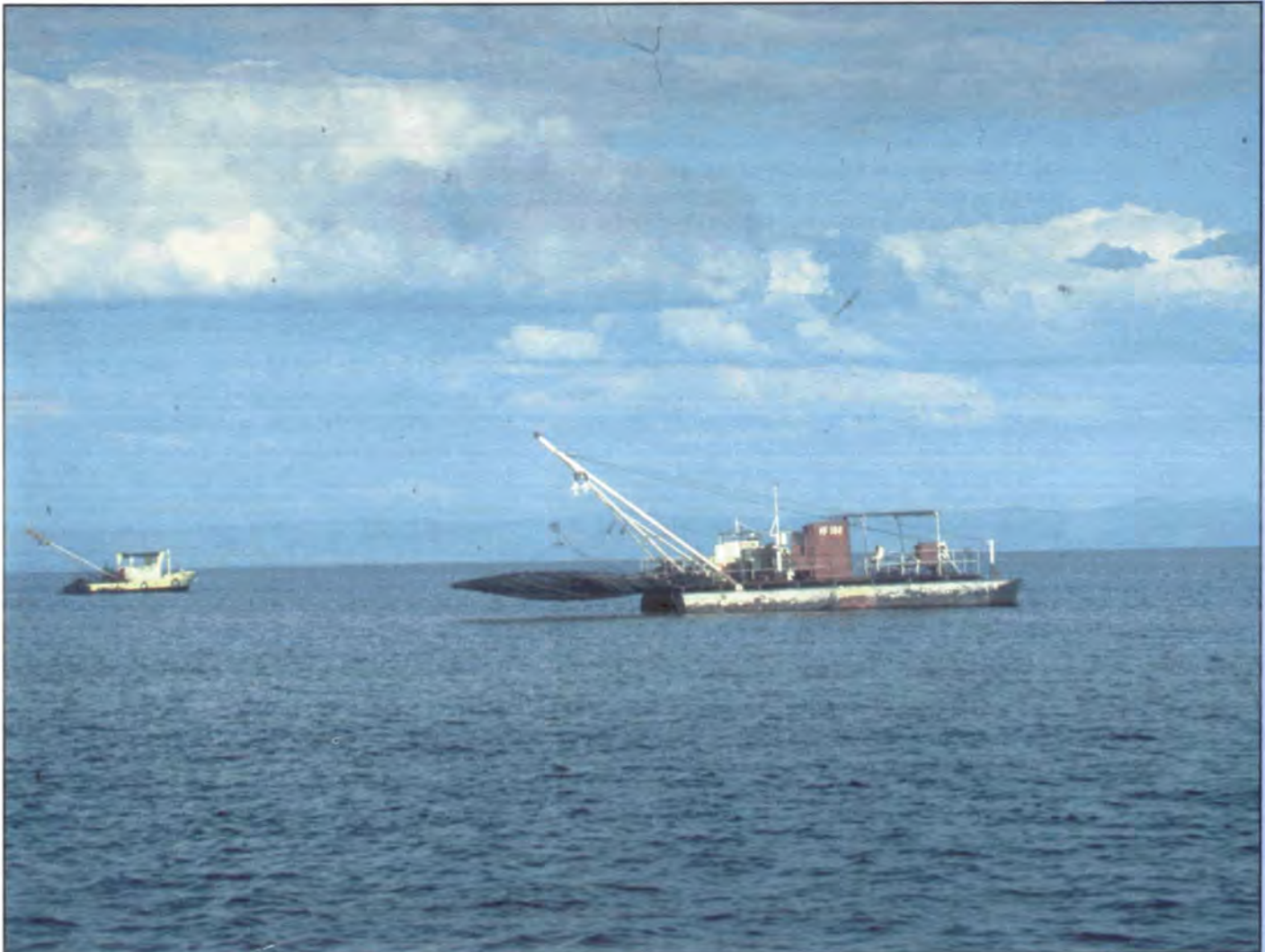
Fig. 4. Kapentariggen, en langsomt gående pontonbåt som fisker stasjonert om natten med håv og lystiltrekking. (Foto: Jeppe Kolding).
