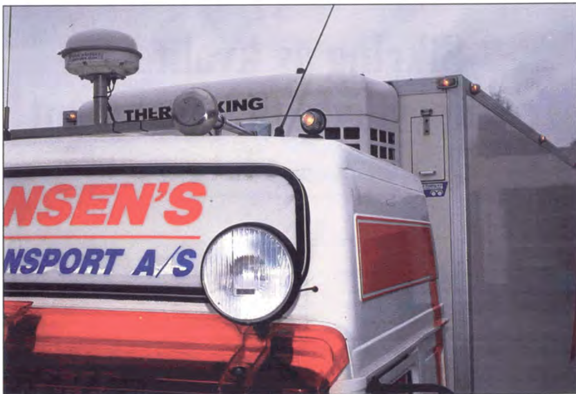
Pålitelige transportsystemer er avgjørende for norsk fiskeeksport. Det siste er satellittkommunikasjon og -tracking. Vogntogetene er utstyrt med satellittutstyr som gjør at man til enhver tid vet hvor vogntoget befinner seg. Systemet kalles ITIT. (Fotos: Marintek).
