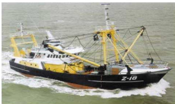
Figur 16. Bilde av en typisk bomtråler og trålarrangementet som fartøyet sleper.
