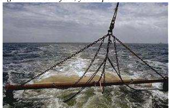
Figur 16. Bilde av en typisk bomtråler og trålarrangementet som fartøyet sleper.
