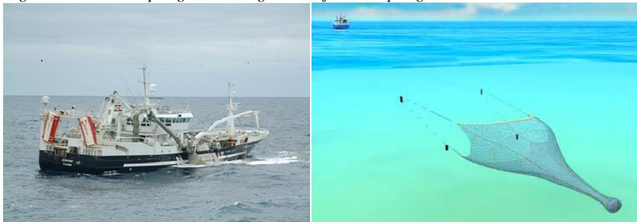
Figur 17. Bilde av en pelagisk tråler og illustrasjon av en pelagisk trål.
