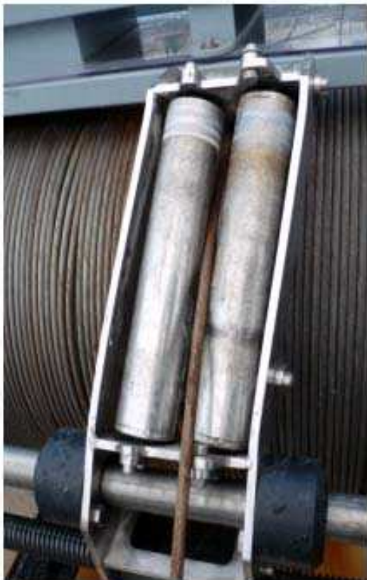
Oben links: Die verzogenen Haltebolzen der Bremsscheibe (Handbremse). Oben rechts: 1050 m Einleiterdraht, über den Spillkopf eingeholt. Unten links: Der verzogene Spurwagen. Unten rechts: Der Ersatz für den Chinese-Finger für die Abweiserdrähte.
